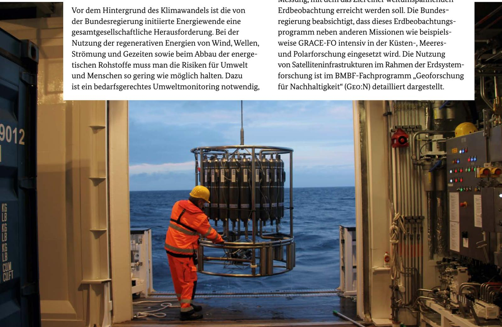
Ein Kranzwasserschöpfer mit Probenmaterial aus verschiedenen Wassertiefen wird an Bord des Forschungsschiffs SONNE geholt.
