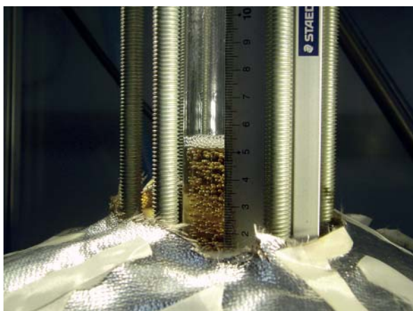
Abbildung 11: Versuchsanlage zur Methanisierung im „Slurry“-Reaktor
