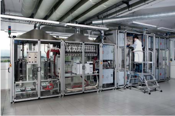
Abbildung 5: Anlage zum Katalysatorscreening
