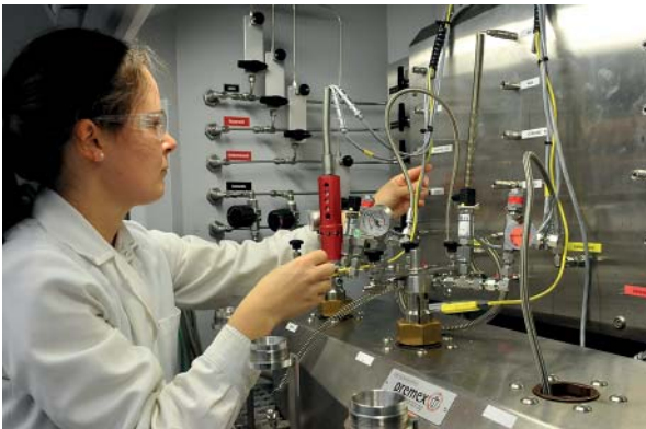
Abbildung 6: Autoklavenstation zur Katalysatorprüfung
