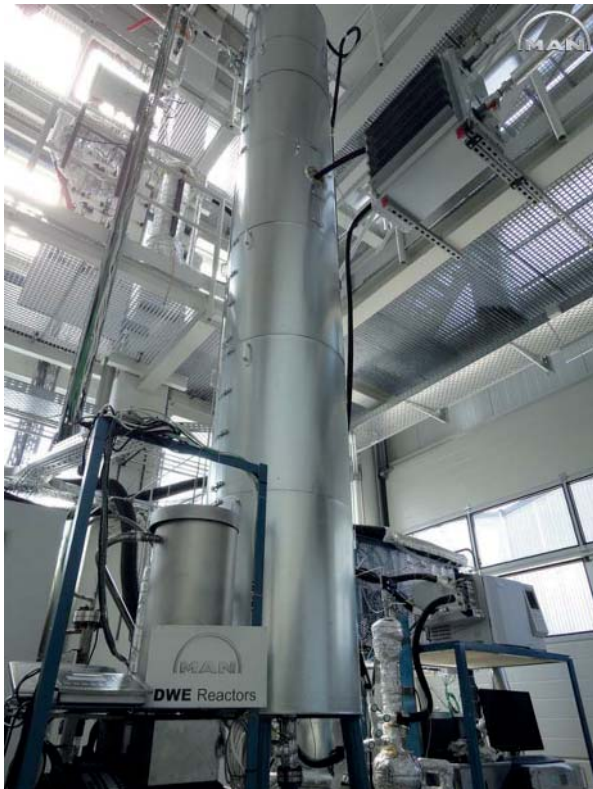
Abbildung 7: Pilotreaktor zur Methanisierung (Teilprojekt COOMeth)
