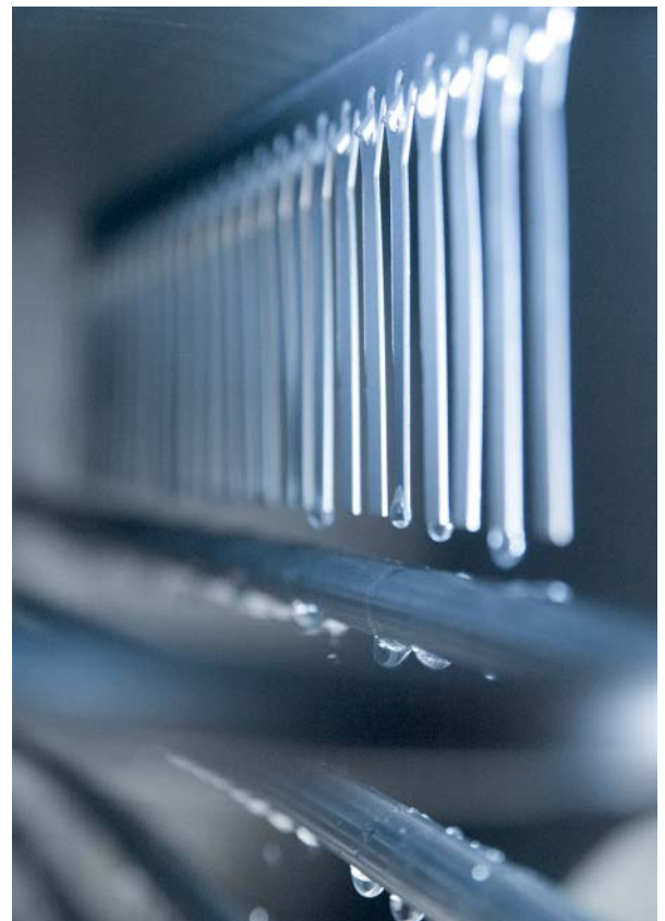
Abbildung 23: Blick in eine Testapparatur zur Validierung neuer Arbeitspaare für Absorptionswärmepumpen
