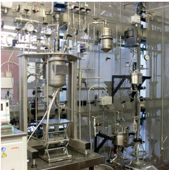
Abbildung 16: Homogenkatalysierte Hydrierung von CO 2 im Miniplantmaßstab
