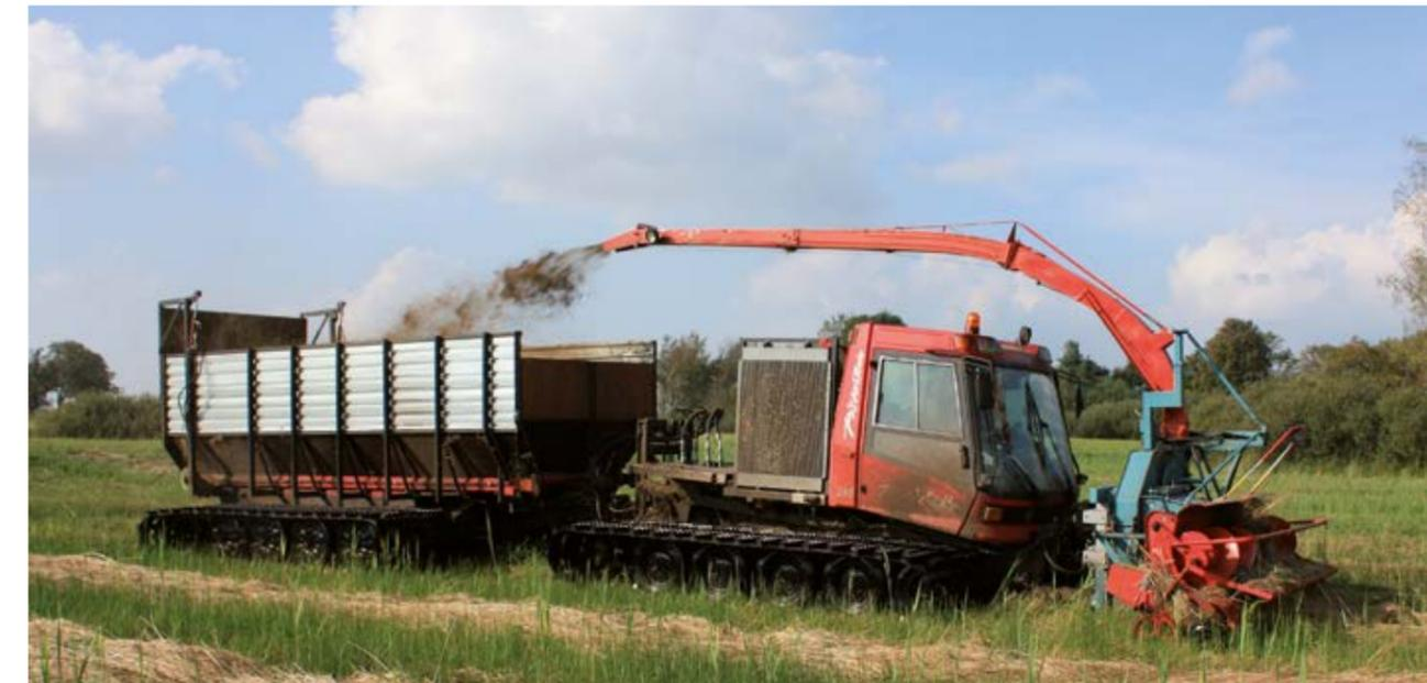
Oberirdische Biomasse aus nassen Mooren wird mit Spezialtechnik geerntet und stofflich bzw. energetisch verwertet.
